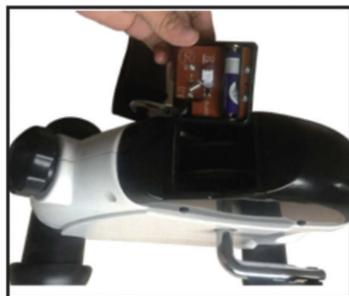
NOTE: Lorsque vous retirez l'ordinateur du haut du corps principal, le fil reliant l'ordinateur à la barre de capteurs peut se déconnecter. Avant de repousser l'ordinateur, veuillez vérifier que le fil est connecté à l'ordinateur et à la barre de capteur.
